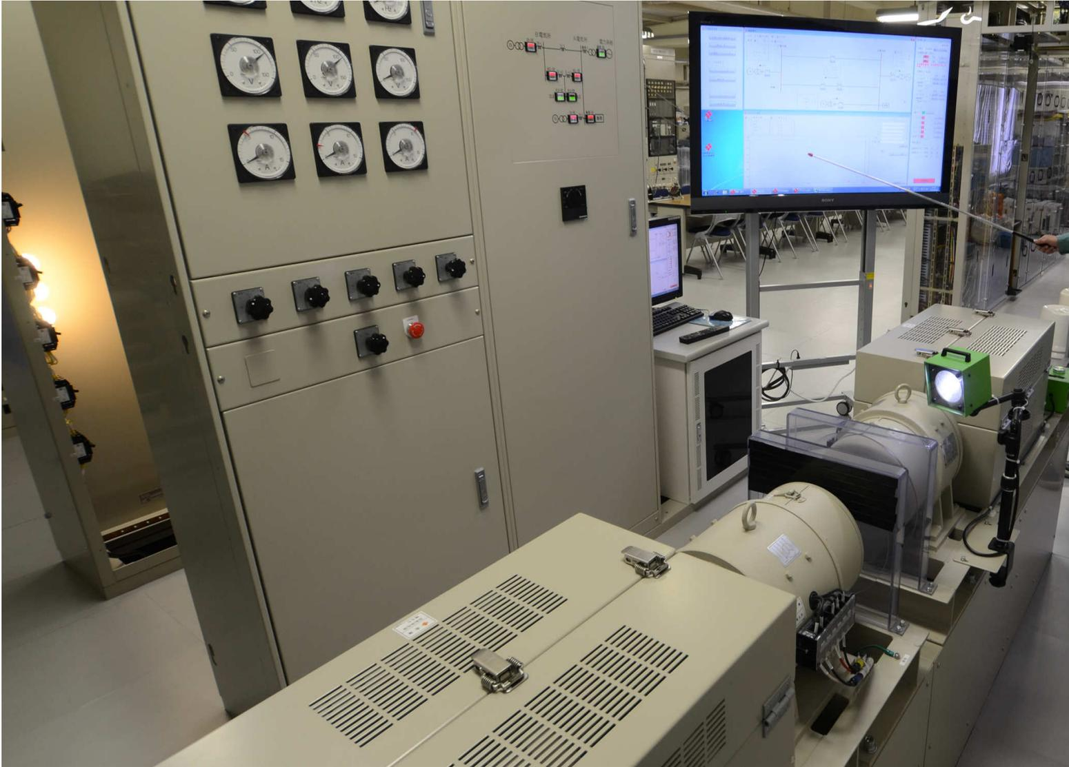
本装置は、模擬送電系統に小型同期発電機を取り付け、発電機出力変更時や系統事故時における発電機の回転状況、系統連系個所の電圧・電流を計測し、ビジュアル化することにより、実際の電気現象に基づく系統安定度の理解促進を図るものです。
